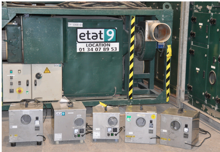
Déshydrateurs à adsorption (débit : 250 à 5 000 m 3 /h)
