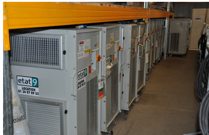
Climatisation autonome réversible (10kW)
