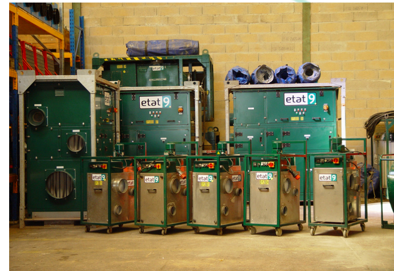
Déshydrateurs à adsorption (débit : 250 à 5 000 m 3 /h)
