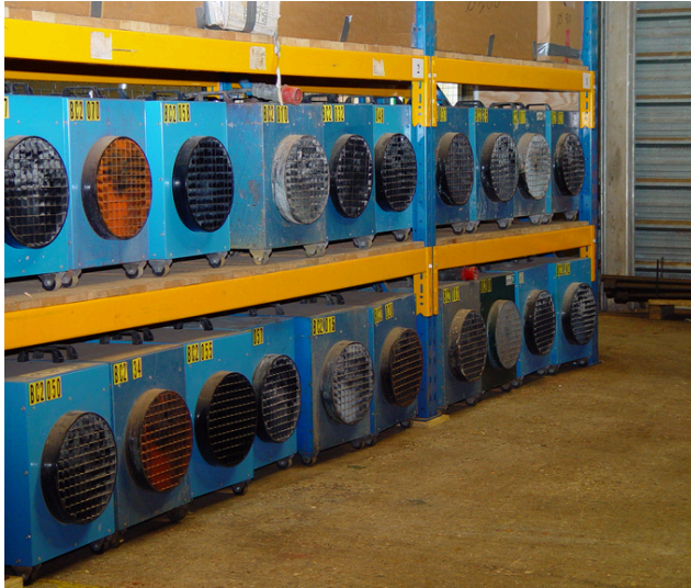
Batterie de chauffe électrique, dynamique et réglable (9, 12, 18 kW)
