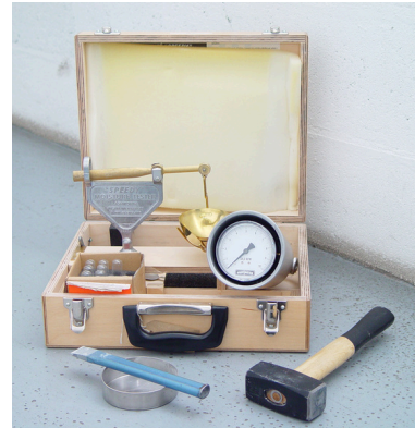
Bombe à carbure- humidité spécifique dans les matériaux
