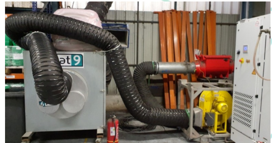
Ventilation Atex avec caisson de filtration
