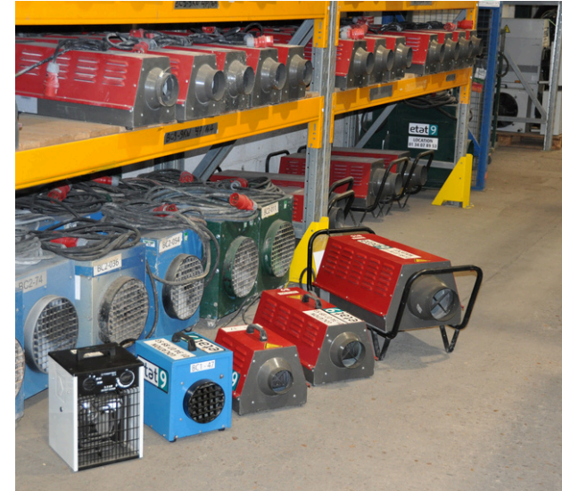
Batterie de chauffe électrique, dynamique et thermostatée de 3 à 18 kW
