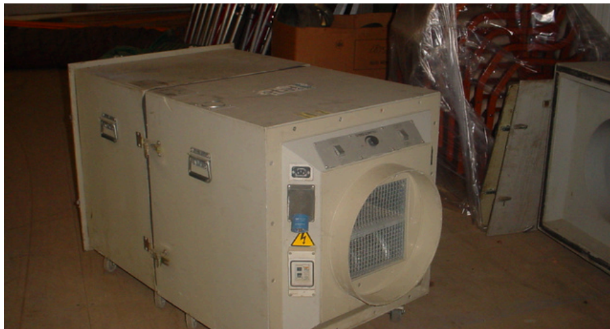
Caisson de filtration (filtre absolue et amiante)
