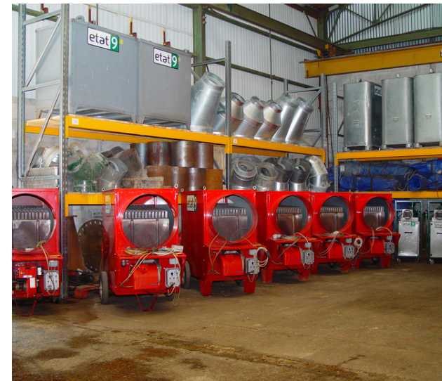
Calomazout puissance de 130 à 220 kW
